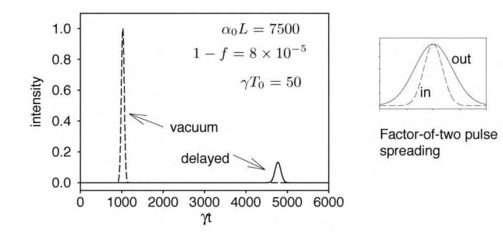
Relative time delay  $T_{\rm del}/T_0 = 75$ .
