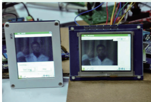
图16 THz实时视频传输系统装置图(左图为发射前的光学视频；右图为通过THz波传输后接收到的实时视频) [61]
